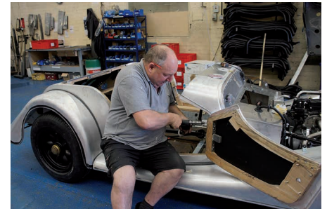
Morganwerk in GB-Malvern Link. Oben: Der Holzrahmen wird in Handarbeit aufgebaut. Unten: Die Metallverkleidung wird auf dem Holzrahmen befestigt. Fotos: Ann Somerset Miles 2011.
