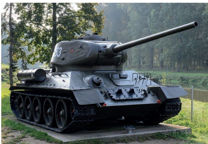
Sowjetischer Panzerkampfwagen T34/85. Im Gegensatz zum Modell fällt die ungetrennte schräge Frontplatte ins Auge. Q.: www.1zoom.me/de
