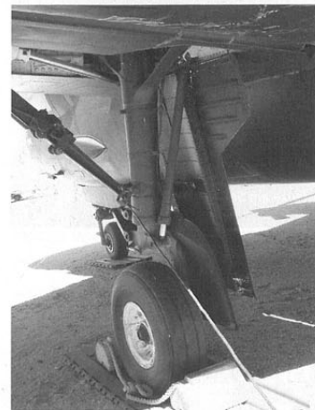
Grumman OV-1-A »Mohawk« Detail Hauptfahrwerk Foto: Sauls Jacoby, Austin, Texas
