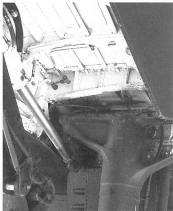
Grumman OV-1-A »Mohawk« Detail Hauptfahrwerk Foto: Sauls Jacoby, Austin, Texas
